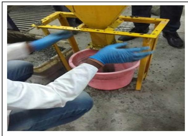
**Fig. 2(b): V-Funnel test**
