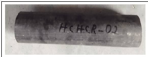
Fig. 1: D2 die steel work piece
