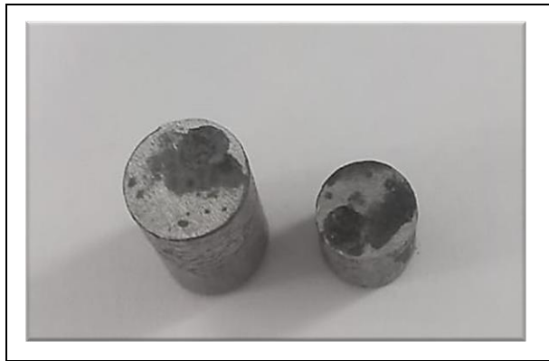
Fig. 2: Nano electrode Al-Ni
